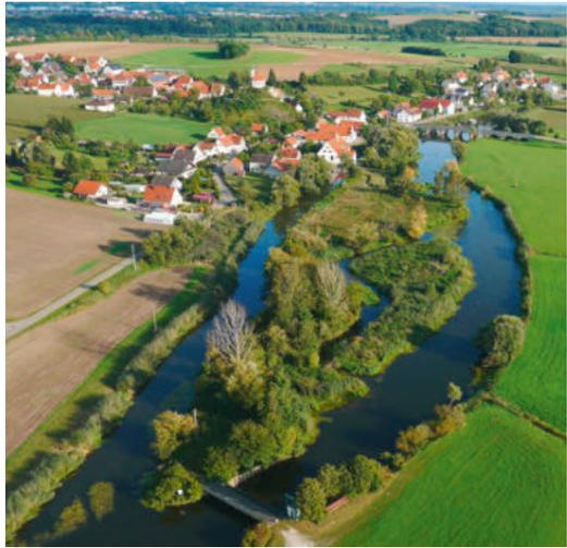
*Wörnitz mit Mühlbach, typisch für die Nutzung der Wasserkraft ist die Aufspaltung in Mühlbach (linker Wasserarm) und Unterlauf. Der Wasserstand wird durch ein Wehr reguliert (Bildvordergrund).*
